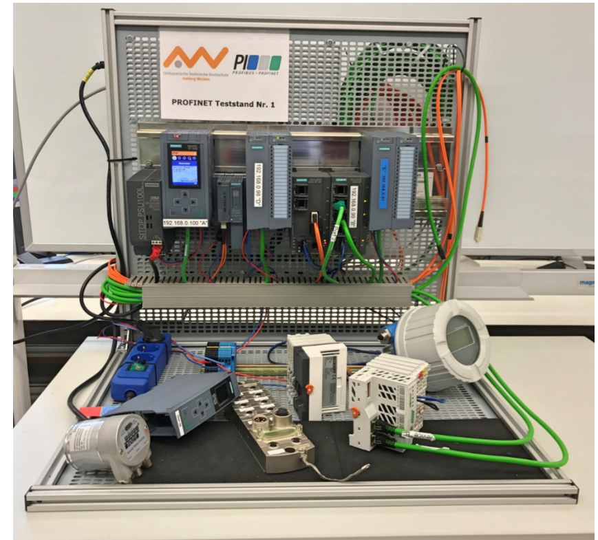
Teststand mit PROFINET Devices von verschiedenen Herstellern
