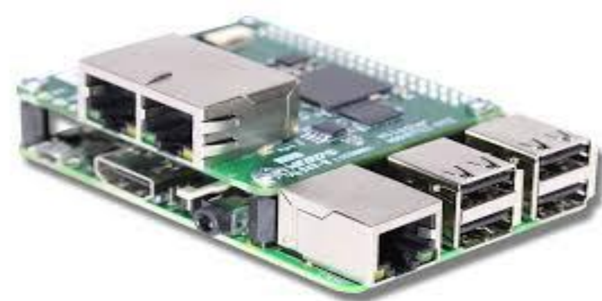
Abb. 4: NetHat (oben) auf Raspberry Pi montiert.
